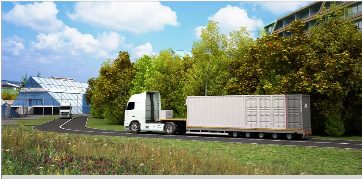
Транспортировка модульных подстанций может производиться автомобильным, железнодорожным или морским транспортом, позволяющим перевозить 40-футовые контейнеры ориентировочной массой до 40 тонн. Модули унифицированы по габариту и соответствуют транспортным стандартам РФ. Соответствие контейнерных блок-модулей транспортному стандарту облегчает логистику на всех этапах и обеспечивает возможность погрузки и разгрузки модулей на терминалах с использованием стандартных средств и оборудования.
