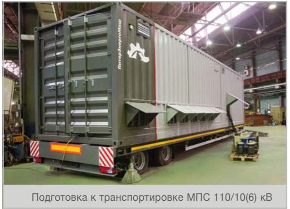
В КОМПЛЕКТ ПОСТАВКИ МПС, В СОСТАВ КОТОРЫХ ВХОДЯТ МОДУЛИ ВЕСОМ БОЛЕЕ 40 ТОНН, ВХОДЯТ ПРИЦЕПЫ ПОВЫШЕННОЙ ГРУЗОПОДЪЕМНОСТИ.
